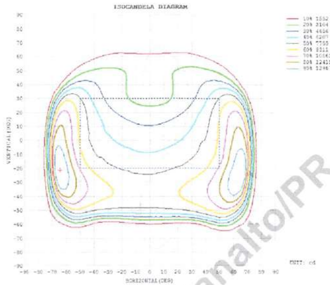
Figura 3 - Curva de distribuição de intensidade (isocandela) (58512-1).
