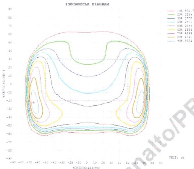
Figura 9 - Curva de distribuição de intensidade (isocandela) (59402-3).
