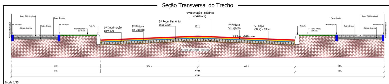
**Detalhe da Estrutura do Pavimento**
