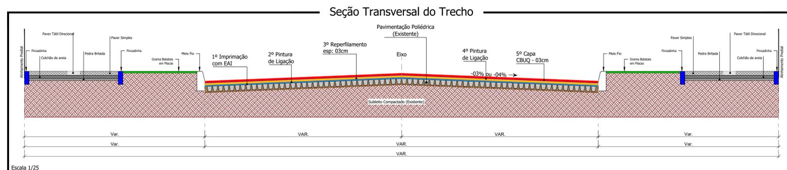
**Detalhe da Estrutura do Pavimento**
