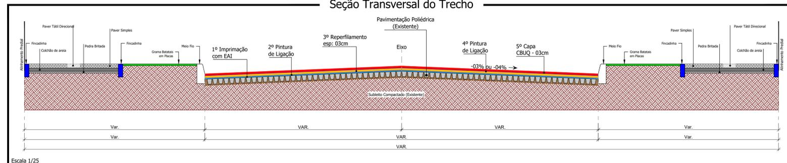
**Detalhe da Estrutura do Pavimento**
