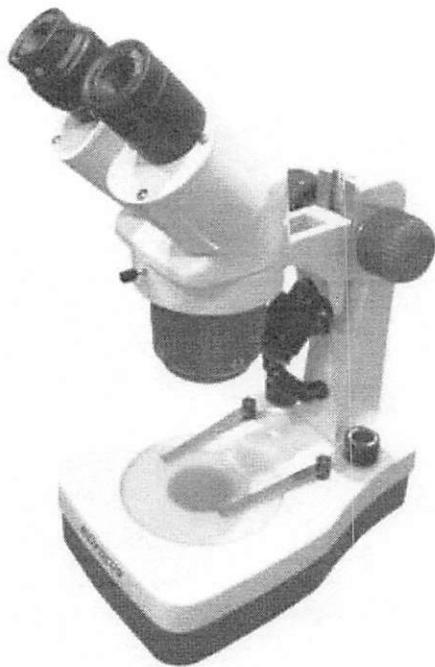
**Estereomicroscópio binocular** com amplo campo de visão, muito utilizado para inspeção, montagem ou manutenção de peças de precisão na indústria eletrônica, para observação e estudo de animais e plantas, usado também em pesquisas científicas, anatomia, biologia, arqueologia, seleção de sementes agrícolas, entre outros.
